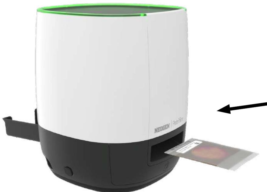
La Placa Neogen Petrifilm debe colocarse de tal manera que la zona de información o la parte de la placa con bisagra esté hacia el dispositivo. Primero será capturada la zona de información y luego la zona de inoculación.
