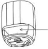
Retire al alimentador manual. Humedezca ligeramente con alcohol isopropílico al 70% un paño de limpieza que no raye y limpie el cristal interior sobre la cavidad del alimentador manual.
