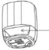
Retire el alimentador manual. Humedezca ligeramente con alcohol isopropílico al 70% un paño de limpieza que no raye y limpie el cristal interior sobre la cavidad del alimentador manual.
